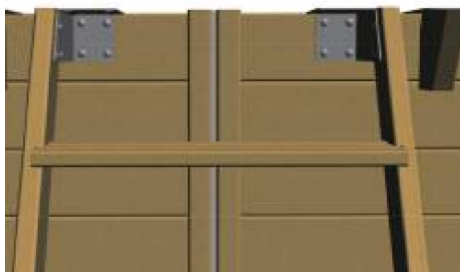
Крепление лестницы с наружной стороны бассейна
