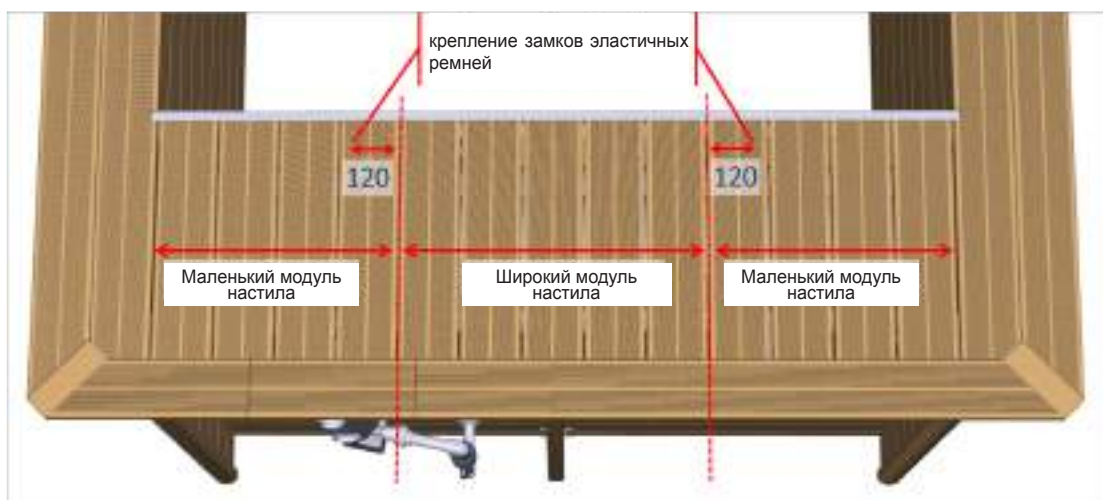
Рисунок 53 – Крепление эластичных ремней под решетками
