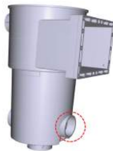
Рисунок 22 – Монтаж вставки-переходника на скиммер
