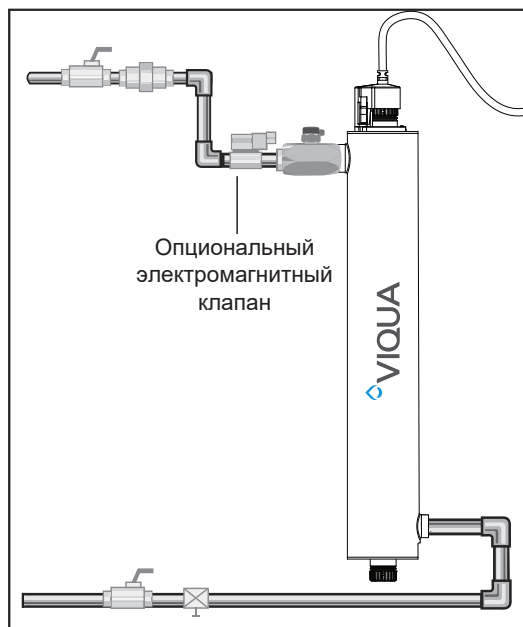
Рисунок 6 Установка электромагнитного клапана
