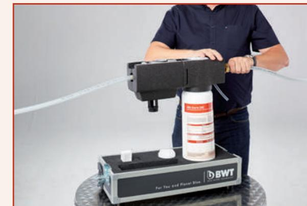
**17.** После заполнения системы закройте все запорные шаровые краны. Чтобы сбросить давление, откройте водопроводный кран на HES и дайте оставшейся воде стечь в ведро, а затем закройте его снова.
