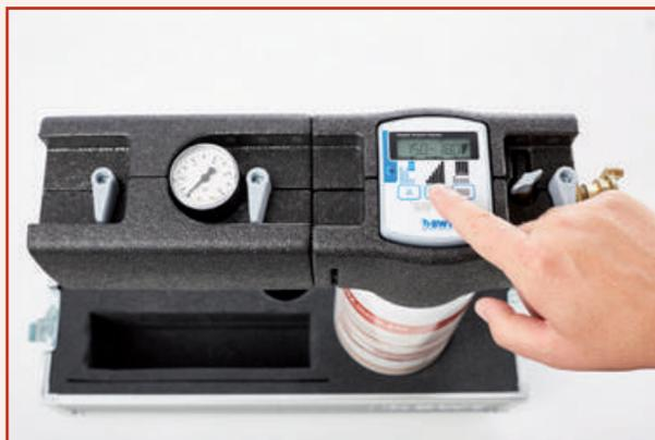
**12.** Включите дисплей клавишей ON / INFO, затем введите диапазон жесткости воды клавишей жесткости / жесткости воды. Доступны следующие диапазоны жесткости воды: 0-6; 7-10; 11-14; 15-18; 19-22; 23-26 °dH
