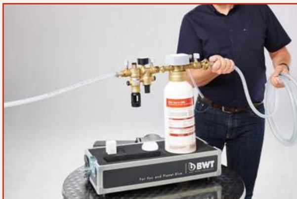
4. Смонтируйте второй шланг с помощью быстроразъемного соединения на выходной стороне станции.
