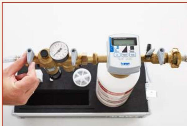
5. Проверьте, все ли шаровые краны закрыты и подключите водопроводную воду ко входу в систему водоподготовки, а выход из нее ко входу в систему отопления
