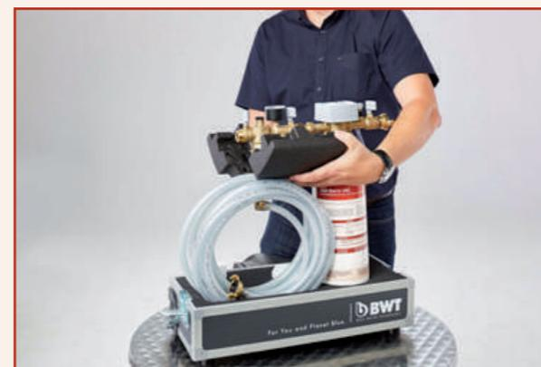
3. Если соединительные шланги еще не смонтированы на корпусе устройства, их необходимо установить. Для этого снимите изоляцию с блока и установите шланг к блоку установки (со стороны впуска), при этом фитинги шланга установлены с обеих сторон.
