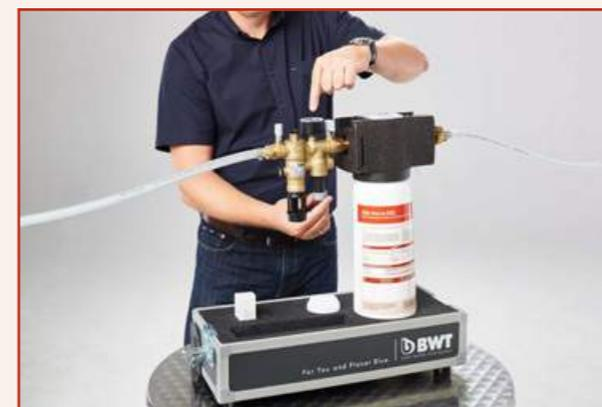
10. На заводе-изготовителе редуктор давления установлен на 1,5 бара. Давление в системе должно быть как минимум на 2 бара выше установленного давления на выходе. Медленно откройте запорный шаровый кран со стороны впуска и поворачивайте регулятор давления, пока манометр не покажет желаемое значение.
