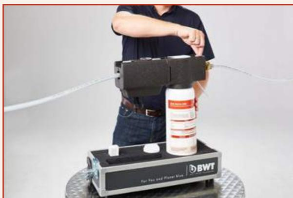
7. Открыв кран на выходе блока проверьте, сброшено ли в нем давление.
