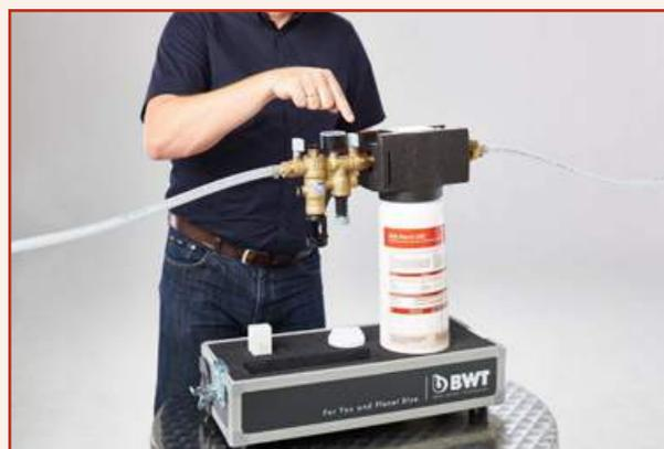
6. Откройте шаровый кран подачи свежей воды на выходной стороне блока заполнения/подпитки.
