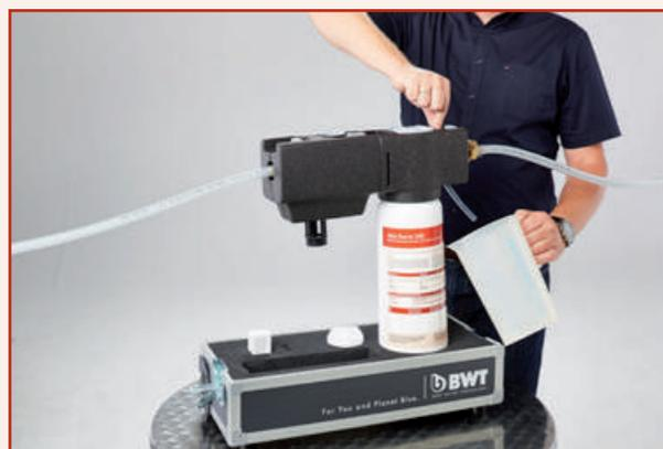
**14.** Перед заполнением системы удалите воздух из картриджа и промойте его. Поставьте под него емкость, откройте вентиляционный клапан на HES-модуле, откройте подачу воды (запорный клапан) со стороны входа и промойте примерно 5 л для HRC/SRC-L; примерно 15л для SRC-XL и примерно 20 л воды для AQA therm HRC-S.
