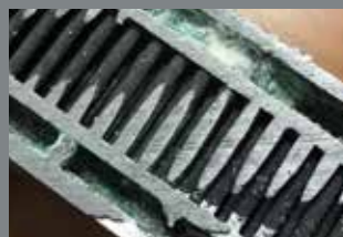
Поперечное сечение корродированного корпуса нагревательного элемента
